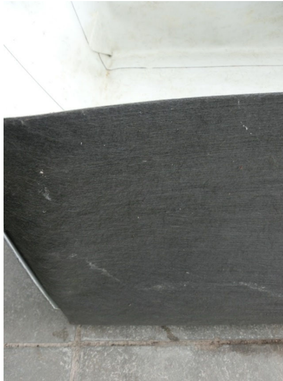
Abb. 1: Anthrazitfarbene Kaschierung an der Bahnunterseite
