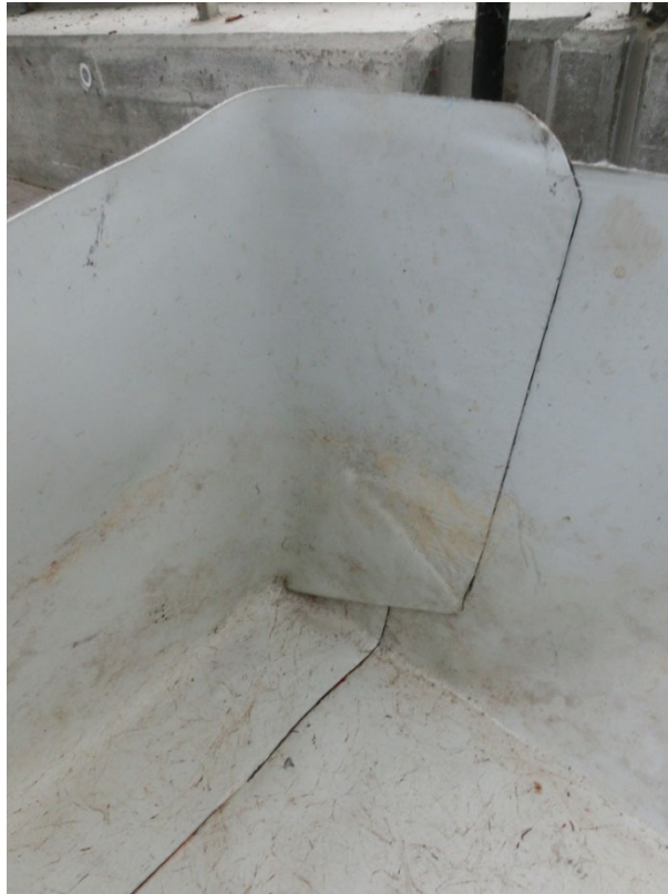
Abb. 3: Eckdetail des Prüfkörpers am Testende
