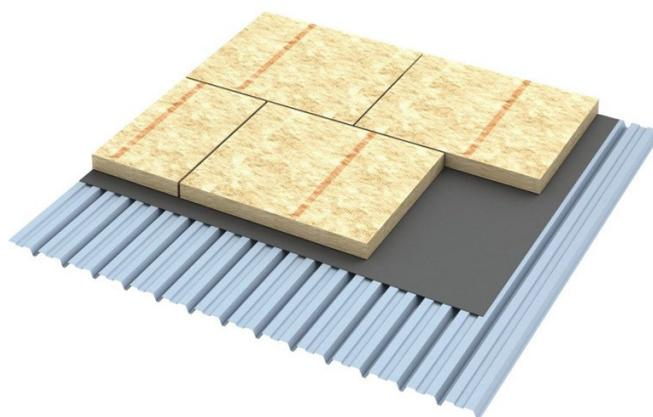
La pose des panneaux en porte-à-faux au-dessus des ondes de la tôle d'acier (panneaux posés perpendiculairement aux ondes) est autorisée moyennant le respect des conditions suivantes:
