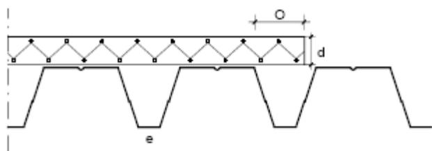
L'ouverture d'onde maximale autorisée (e) dépend de l'épaisseur de l'isolation :  $e \leq 3 \times d$ , avec :
