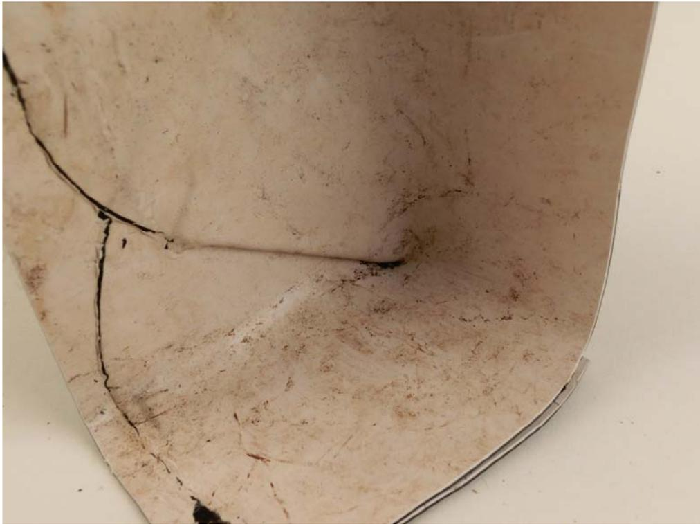
**Abbildung 3:** Ecknaht mit Quetschfalte
