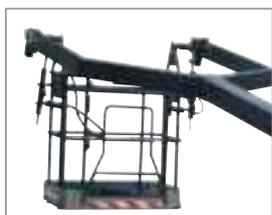
La nacelle pendulaire permet de travailler sous un pont.
