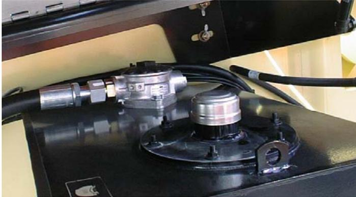
Point(s) de lubrification — Bouchon de remplissage
