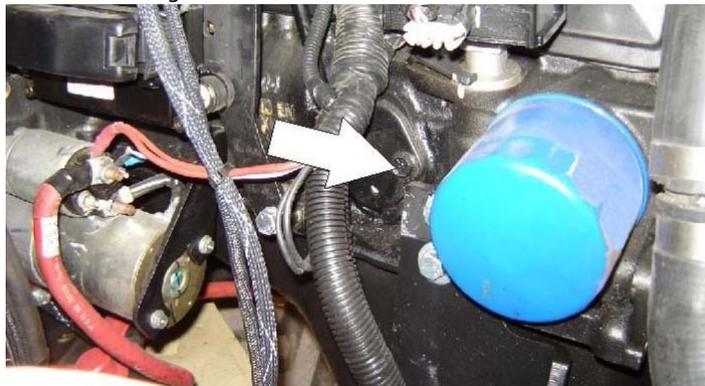
Point(s) de lubrification — Bouchon de remplissage/élément vissable
