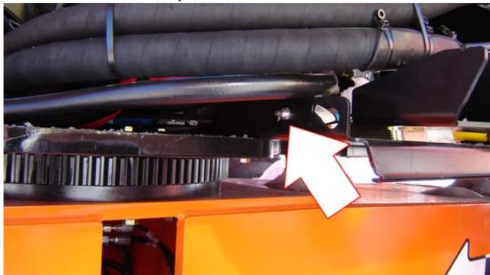
Point(s) de lubrification — 1 graisseur
