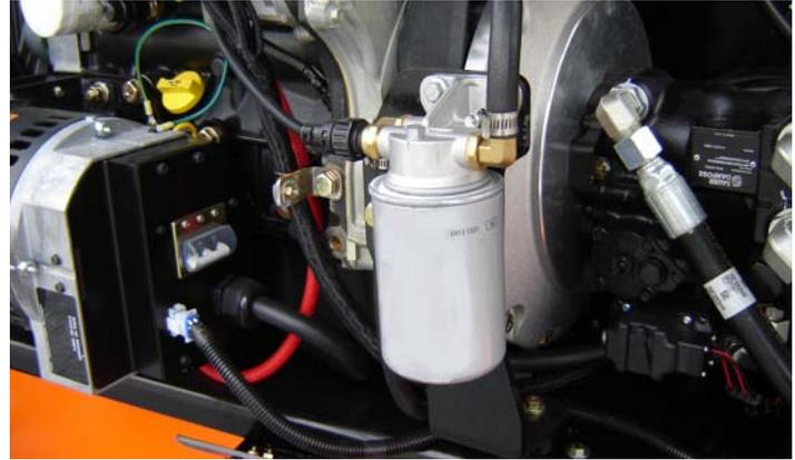
Point(s) de lubrification — Élément remplaçable
