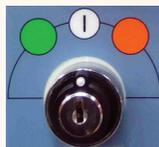
Cette opération coupe l'alimentation électrique à la machine et est nécessaire pour empêcher le déchargement de la batterie.
