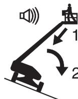
Si l'alarme de dévers retentit avec la nacelle relevée en descente :
