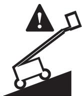
Si l'alarme de dévers retentit avec la nacelle relevée, le témoin de machine inclinée s'allume et la fonction de translation dans un sens ou les deux ne s'active pas. Déterminer la position de la flèche sur la pente, comme illustré ci-dessous. Abaisser la flèche conformément aux instructions avant de déplacer la machine sur une surface ferme et plane. Ne pas faire pivoter la flèche en l'abaissant.
