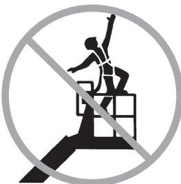
Ne pas s'asseoir, se tenir debout, ni monter sur les rampes de sécurité de la nacelle. Garder constamment les deux pieds fermement posés sur le plancher de la nacelle.
