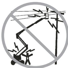
Rester éloigné de la machine si elle touche des lignes sous tension. Le personnel au sol ou à bord de la nacelle ne doit ni toucher, ni utiliser la machine tant que les lignes électriques sont sous tension.
