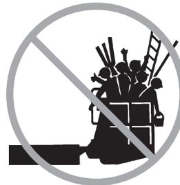
Ne pas placer d'échelle ni d'échafaudage dans la nacelle, ni contre une partie de la machine.
