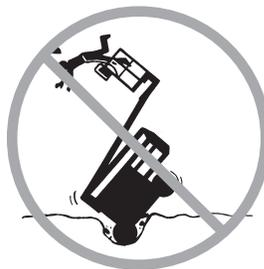
Faire preuve d'une extrême prudence et rouler lentement en conduisant la machine en position repliée sur un terrain irrégulier, des débris, des surfaces meubles ou glissantes ou près de trous et de dévers.
