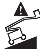
Le témoin allumé indique que la machine est inclinée. L'alarme de dévers retentit lorsque ce témoin est allumé. Placer la machine sur une surface ferme et plane.
