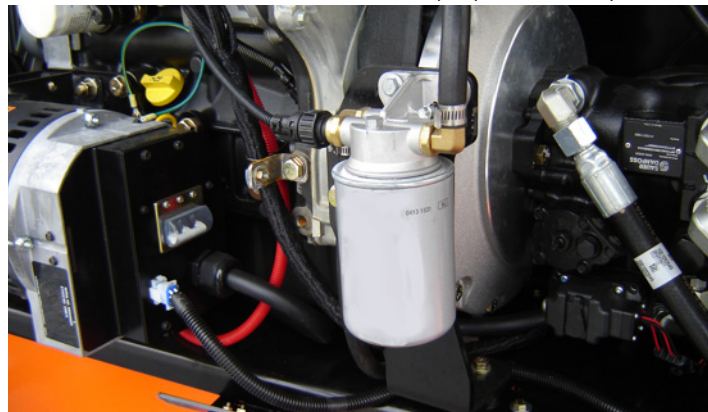
C. Filtre à carburant – Deutz TD 2,9 I (sur le moteur)
