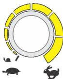
Pour passer en vitesse d'approche, tourner le bouton complètement vers la gauche jusqu'au dé clic. La vitesse d'approche sélectionne le réglage de vitesse le plus lent pour les fonctions énumérées ci-dessus, ainsi que les fonctions Translation/direction et Relevage/pivotement de la flèche principale.
