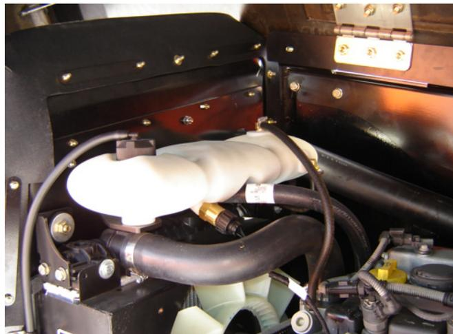
Point(s) de lubrification - Bouchon de remplissage
